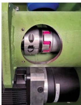
Particolare giunto elastico motoriduttore-asse macchina.
